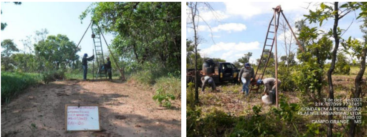
Figura 5.43 – Execução de sondagens SPT na Área Específica de Análise Ambiental, UG04 e UG06 respectivamente
