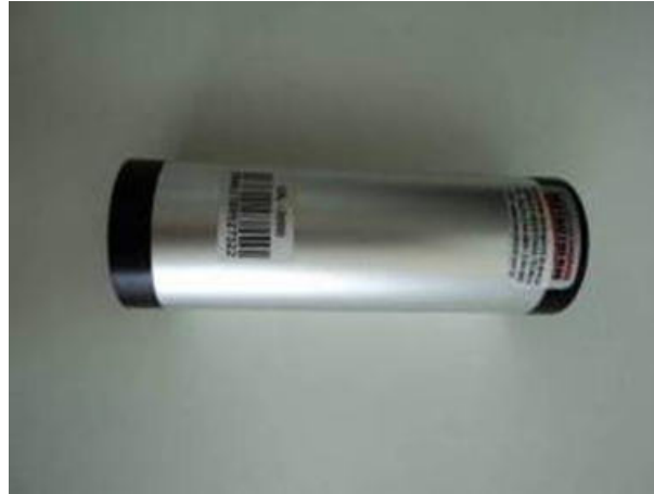
Figura 5.15 – Calibrador sonoro – Instrutherm, modelo CAL – 3000
