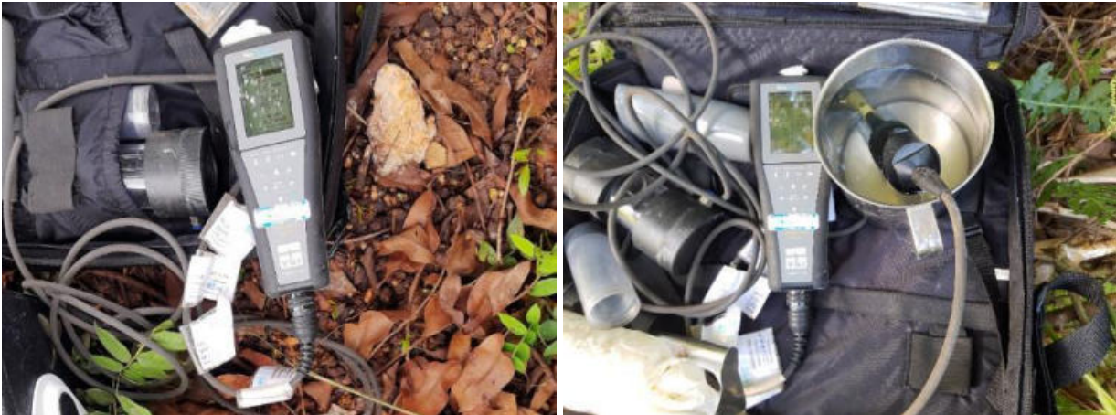
Figura 5.99 – Aferição de variáveis em campo por meio do emprego de sonda multiparâmetro YSI Professional Series ProQuatro
