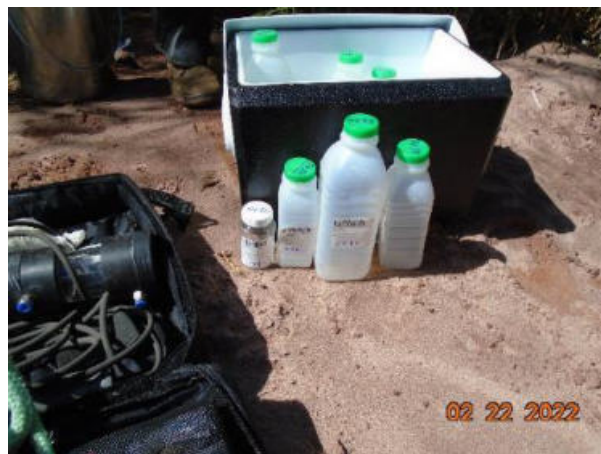
Figura 5.98 – Vista do acondicionamento das amostras de águas superficiais em caixa térmica refrigerada
