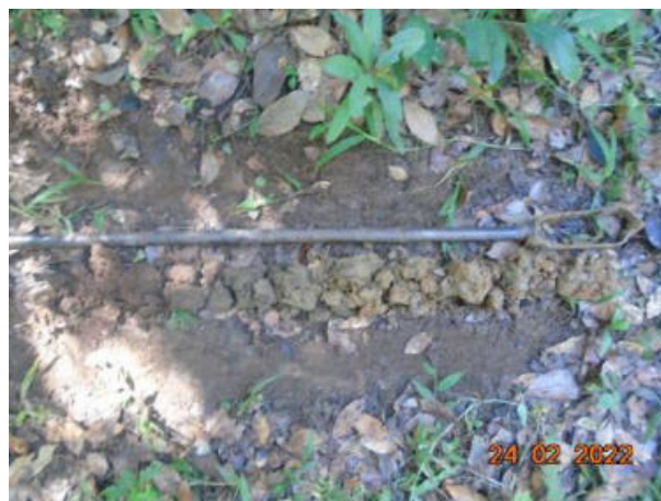
Figura 5.63 – Aspecto de perfil à trado em Argissolo Amarelo
