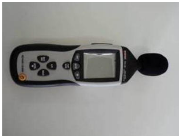
Figura 5.14 – Sonômetro Instrutherm, modelo DEC-490
